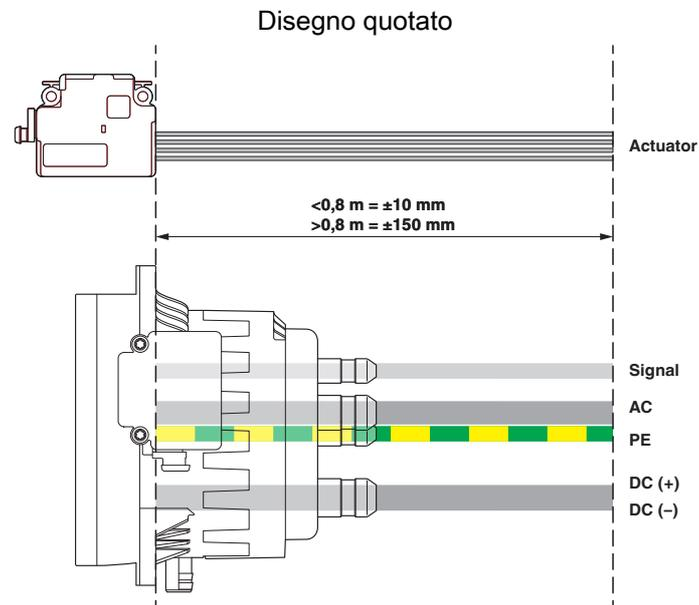
Punti di riferimento per la misurazione della lunghezza del cavo
