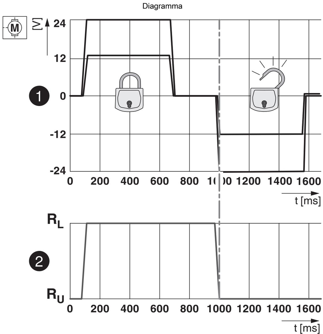
Stati di blocco dell'attuatore di bloccaggio
