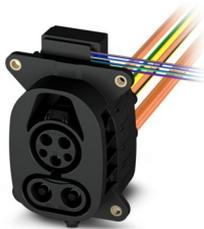
CHARX connect universal, AC/DC CCS Typ 1, Presa di ricarica del veicolo, 250 A permanente, 1000 V DC, 80 A , 250 V AC, Fili singoli, lunghezza: 2 m, attuatore di bloccaggio: 12 V, 4 poli, Montaggio sulla parete anteriore e posteriore, M6, custodia: nero, per la ricarica con corrente alternata (AC) e corrente continua (DC), IEC 62196-2, IEC 62196-3, La fornitura comprende un cappuccio di protezione per i contatti DC e AC.
