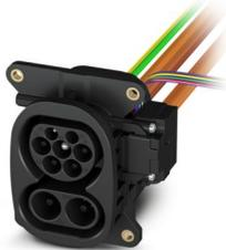
CHARX connect universal, AC/DC CCS Typ 2, Presa di ricarica del veicolo, fino a 500 A in Boost mode, 200 A permanente, 1000 V DC, 32 A , 480 V AC, Fili singoli, lunghezza: 2 m, attuatore di bloccaggio: 12 V, 4 poli, Montaggio sulla parete anteriore e posteriore, M6, custodia: nero, per la ricarica con corrente alternata (AC) e corrente continua (DC), IEC 62196-2, IEC 62196-3, La fornitura comprende un cappuccio di protezione per i contatti DC e AC.
