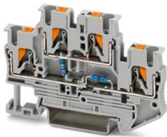
Componente morsetto componibile, tipo di connessione: Connessione Push-in, 1. e 2. piano, Sezione di dimensionamento: 2,5 mm<sup>2</sup>, sezione: 0,14 mm<sup>2</sup> - 4 mm<sup>2</sup>, tipo di montaggio: NS 35/7,5, NS 35/15, colore: grigio
