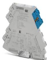
Ex i-Isolatore galvanico NAMUR per la gestione di sensori di prossimità e interruttori nella zona Ex. I segnali vengono trasmessi nella zona sicura mediante 2 uscite del transistor (passive). Configurazione standard, Riconoscimento guasto linea, Safety Integrity Level (SIL, IEC 61508): 3, Connessione a vite
