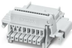
Connettore per guide di supporto, colore: grigio chiaro, corrente nominale: 6 A, 4 A (contatti paralleli) (contatti seriali), tensione di dimensionamento (III/2): 32 V, numero poli: 8, serie di prodotti: TBUS8-25.., passo: 2,54 mm, montaggio: Montaggio su guida DIN, bloccaggio: assente, tipo di fissaggio: assente, tipo di confezione: confezionato nel cartone, Articolo con contatti dorati, connettore bus per il collegamento con custodie per l'elettronica, 4 contatti paralleli/4 contatti seriali
