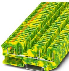
Morsetti comp. per conduttori terra, tipo di connessione: Push-in / attacco connettore, sezione: 0,2 mm<sup>2</sup> - 6 mm<sup>2</sup>, tipo di montaggio: NS 35/7,5, NS 35/15, colore: giallo-verde
