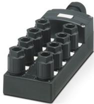
Scatola di distribuzione, tipo di connessione: QUICKON, 0,14 mm<sup>2</sup> ... 0,75 mm<sup>2</sup>, numero degli slot: 8, numero poli: 5, occupazione slot: doppi, segnalazione di stato: no, Universale; connessione linea principale: Morsetto a vite estraibile 180°, schermatura: no, Con il collegamento di 5 conduttori sono collegabili max. 0,5 mm<sup>2</sup>
