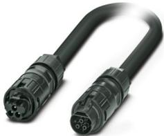
Linea di connessione, Serie di prodotti: PRC 35, colore: nero, numero poli: 3, tensione di dimensionamento: 690 V AC, corrente nominale: 24 A, Tipo di connessione: Connessione a vite, Tipo di connessione del contatto: Femmina/maschio, Questo articolo è disponibile anche con altre lunghezze di cavo. Per esigenze particolari contattare la filiale PHOENIX CONTACT locale.
