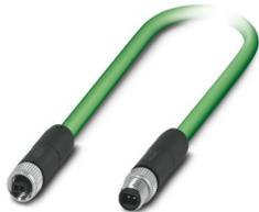
Cavo di rete, Single Pair Ethernet CAT B (1 Gbit/s), 2-poli, PUR senza alogenati, verde, schermata (Advanced Shielding Technology), Maschio diritto M8-SPE / IP67, su Connettore femmina diritto M8-SPE / IP67, lunghezza cavo: 2 m
