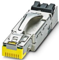
Connettore RJ45, tipo: RJ45, grado di protezione: IP20, numero poli: 8, 10 Gbit/s, CAT6<sub>A</sub>, materiale: Metallo, tipo di connessione: Connessione a perforazione di isolante, sezione di connessione: AWG 23- 22, uscita cavo: diritto, colore: giallo, Ethernet
