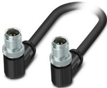
Cavo ibrido, Ethernet ibrido CAT5 (100 MBit/s), 8-poli, PUR senza alogenati, nero RAL 9005, schermata (Advanced Shielding Technology), Maschio angolato M12, codifica: Y / IP65/IP67, su Maschio angolato M12, codifica: Y / IP65/IP67, lunghezza cavo: 1 m, Power with Ethernet (PWE)
