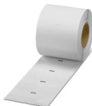
Etichetta segnacavi, Rotolo, bianco, in bianco, siglabile con: THERMOMARK ROLLMASTER 300/600, THERMOMARK X1.2, THERMOMARK ROLL X1, THERMOMARK ROLL 2.0, THERMOMARK ROLL, THERMOMARK S1.1, diametro cavi: 4 ... 7,6 mm, tipo di montaggio: colla, diametro cavo: ≤ 7,6 mm, Numero dei cartellini singoli: 5000, altezza del campo di testo: 12,7 mm, larghezza del campo di testo: 25,4 mm
