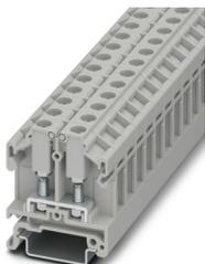
Morsetto di collegamento a bullone, con viti per prese di prova per l'alloggiamento di spine di prova, tensione nominale: 1000 V, corrente nominale: 41 A, tipo di connessione: Bullone, Sezione di dimensionamento: 6 mm<sup>2</sup>, sezione: 0,5 mm<sup>2</sup> - 6 mm<sup>2</sup>, tipo di montaggio: NS 35/7,5, NS 35/15, colore: grigio
