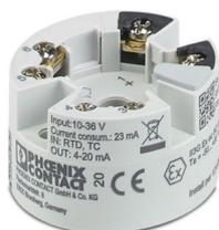
Trasmettitore da installare sulla testina con alimentazione per loop di uscita per la trasmissione di segnali di sensori RTD e TC e di trasduttori di resistenza e tensione di 4 mA ... 20 mA. HART, Configurazione standard, Connessione a vite
