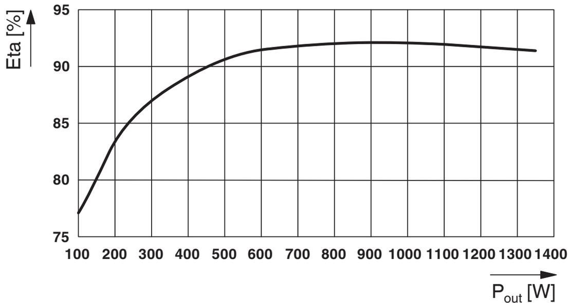
Livello di efficienza (funzionamento a batteria)
