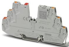
Fusibile elettronico a un canale per la protezione delle utenze da 24 V. Semplice ripartizione del potenziale con morsetti componibili provenienti dal sistema CLIPLINE complete. Con uscita di stato, ingresso di reset e interblocco elettronico. Per l'installazione su guide DIN.
