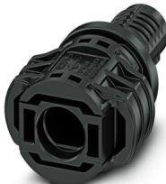
Connettore per apparecchi anteriore, Serie di prodotti: SUNCLIX, colore: nero, numero poli: 1, sezione del conduttore min.: 2,5 mm<sup>2</sup>, sezione del conduttore max.: 6 mm<sup>2</sup>, tensione di dimensionamento: 1500 V DC, corrente nominale: 38 A, Tipo di connessione: A crimpare, Tipo di connessione del contatto: Spina
