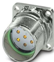
M23, Connettore per apparecchi anteriore, serie: M23 PRO, diritto, schermati: sì, Per il bloccaggio rapido standard e ONECLICK, Numero di poli: 7, Senso di rotazione: standard, tipo di connessione del contatto: Femmina, Connessione a crimpare, 4x Ø 2,7 mm, misura flangia: 26 mm x 26 mm, codifica: N, L'articolo è senza piombo secondo la direttiva RoHS II senza eccezione 6c (Pb < 0,1 %)
