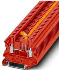
Morsetto con sezionatore a coltello, tensione nominale: 400 V, corrente nominale: 20 A, tipo di connessione: Connessione a vite, Sezione di dimensionamento: 2,5 mm<sup>2</sup>, sezione: 0,14 mm<sup>2</sup> - 4 mm<sup>2</sup>, montaggio: NS 35/7,5, NS 35/15, colore: rosso
