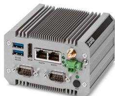
Box PC (BPC) industriale senza ventola, con grado di protezione IP30 con efficiente processore Intel® Celeron® N3350, memoria di massa eMMC da 32 GB, uno slot M.2 aperto e 2 porte COM
