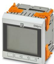
Dispositivo per la misurazione dell'energia multifunzionale con alimentazione da 24 V DC, connessione Rogowski diretta e interfaccia Modbus/TCP integrata per la misurazione di parametri elettrici in impianti a bassa tensione fino a 690 V ([phoenixcontact.com/empro-help](https://www.phoenixcontact.com/empro-help))
