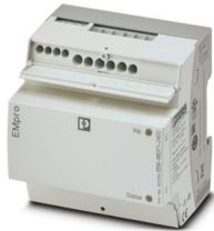
Dispositivo per la misurazione dell'energia multifunzionale senza display con alimentazione da 24 V DC, connessione Rogowski diretta e interfaccia Modbus/TCP integrata per la misurazione di parametri elettrici in impianti a bassa tensione fino a 690 V ([phoenixcontact.com/empro-help](https://www.phoenixcontact.com/empro-help))
