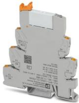
PLC INTERFACE contro le correnti di interferenza o le tensioni di interferenza sul lato di controllo. Composta da morsetto base PLC-BPT-120UC/21/SO46 con connessione Push-in e relè in miniatura a innesto con contatto di potenza fino a 6 A, 1 contatto di scambio, tensione di ingresso 120 V AC
