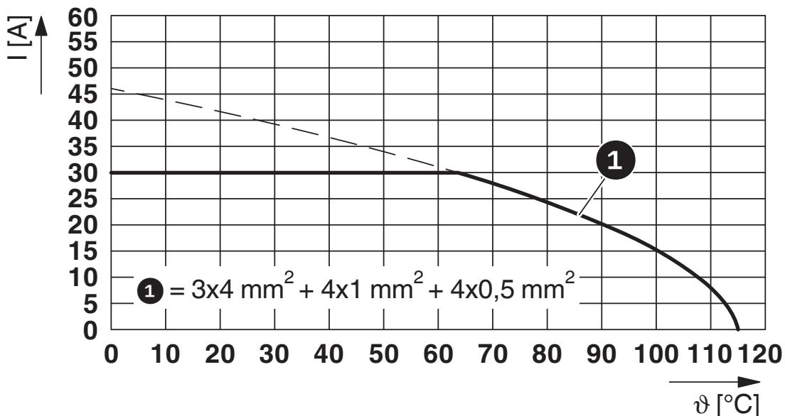
$I$  = intensità di corrente,  $\vartheta$  = temperatura ambiente, contatti di potenza A-C: 3 x fino a 30 A, contatti di segnalazione: 4 x 2 A costante, contatti dati: 4 x 1 A costante
