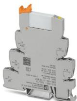
PLC-INTERFACE, composta da morsetto base PLC-BSC.../21 con connessione a vite e relè in miniatura a innesto con contatto di potenza, per montaggio su guida di supporto NS 35/7,5, 1 contatto di scambio, tensione di ingresso 5 V DC
