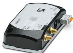
WLAN Access Point, client, mesh per USA e Canada, con due collegamenti per antenna esterni (RSMA-F), IP20, WLAN 802.11a, b, g, n, frequenza: 2,4 GHz, 5 GHz, porte: COMBICON 9 V DC ... 32 V DC, RJ45: per LAN, Web, http/https, CLI, REST-API
