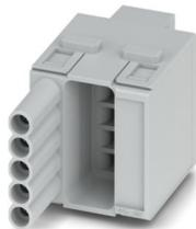
Modulo portacontatti, numero poli: 5, contatti di potenza: 5, Femmina, Connessione Push-in, 400 V, 16 A, 0,5 mm<sup>2</sup> ... 2,5 mm<sup>2</sup>, applicazione: Potenza, con zona di sezionamento per spine portafusibili, portacomponenti e di sezionamento
