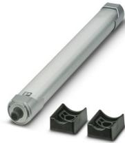
Illuminazione macchine a LED, 24 V DC, angolo di diffusione (verticale/orizzontale): 85 °/101 °, lunghezza: 615 mm, dimensioni: 35 mm, grado di protezione: IP54, orientabile, Variazione della luce, collegabile in serie
