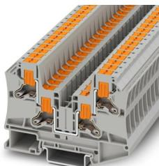
Morsetto passante, tensione nominale: 1000 V, corrente nominale: 41 A, numero di connessioni: 4, numero poli: 1, tipo di connessione: Connessione Push-in, Sezione di dimensionamento: 6 mm<sup>2</sup>, sezione: 0,5 mm<sup>2</sup> - 10 mm<sup>2</sup>, tipo di montaggio: NS 35/7,5, NS 35/15, colore: grigio
