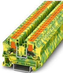
Morsetti comp. per conduttori terra, numero di connessioni: 2, numero poli: 1, tipo di connessione: Connessione Push-in, Sezione di dimensionamento: 6 mm<sup>2</sup>, sezione: 0,5 mm<sup>2</sup> - 10 mm<sup>2</sup>, tipo di montaggio: NS 35/7,5, NS 35/15, colore: giallo-verde
