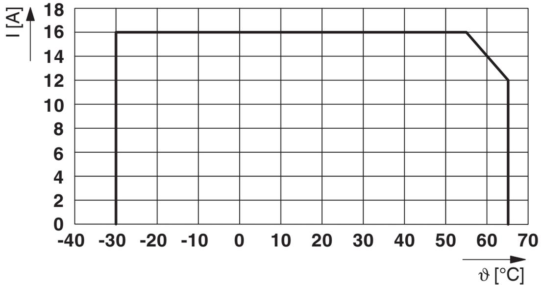
Corrente max. ammissibile in funzione della temperatura ambiente
