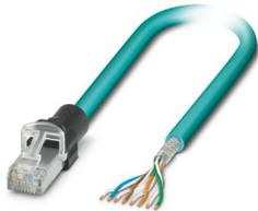
Cavo patch, grado di protezione: IP20, lunghezza cavo: 1 m, numero poli: 8, 1 Gbit/s, CAT5, materiale: PP, tipo di connessione: Connessione Pierce, sezione di connessione: AWG 26- 26, uscita cavo: diritto, Ethernet
