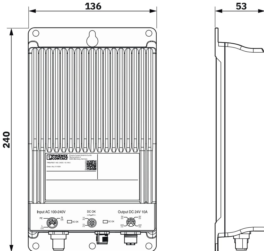
Dimensioni del dispositivo (misure in mm)
