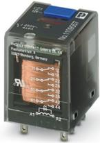
Relè industriale a innesto nell'esecuzione base con contatti di potenza, 4 contatti di scambio, tasto di prova, LED di stato, diodo di smorzamento, segnalazione meccanica di stato, polarità A1+, A2-, tensione d'ingresso: 12 V DC
