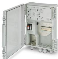
Smart Ethernet Box per il collegamento di dispositivi terminali PoE, due porte PoE, due porte uplink (slot SFP), Switch Managed, protezione contro la sovratensione e scatola di giunzione integrati, tensione di alimentazione 100 ... 240 V AC, montaggio a parete o a palo
