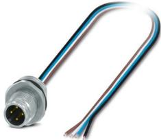
Connettore per apparecchi anteriore, Universale, 4-poli, Connettore, diritto, M12-Bloccaggio esterno Push-Pull, codifica: A, su estremità conduttore libera, Montaggio anteriore, M16 x 1,5, Fili singoli, lunghezza cavo: 0,5 m, 0,34 mm<sup>2</sup>, Filo in TPE, saldato, L'articolo è senza piombo secondo la direttiva RoHS II senza eccezione 6c (Pb < 0,1 %)
