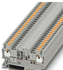
Morsetto passante componibile, Corrente e tensione sono determinate dalla spina impiegata., tensione nominale: 400 V, corrente nominale: 16 A, tipo di connessione: Connessione Push-in, Sezione di dimensionamento: 2,5 mm<sup>2</sup>, sezione: 0,14 mm<sup>2</sup> - 4 mm<sup>2</sup>, montaggio: NS 35/7,5, NS 35/15, colore: grigio
