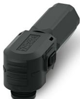
Connettore, Serie di prodotti: BPC, colore: nero, numero poli: 1, sezione del conduttore min.: 16 mm<sup>2</sup>, sezione del conduttore max.: 25 mm<sup>2</sup>, tensione di dimensionamento: 1500, corrente nominale: 120 A, Tipo di connessione: A crimpare, Tipo di connessione del contatto: Femmina, diametro cavo min.: 7,2 mm, diametro cavo max.: 10,7 mm
