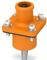
Connettore, Serie di prodotti: BPC, colore: arancione, numero poli: 1, sezione del conduttore min.: 16 mm<sup>2</sup>, sezione del conduttore max.: 25 mm<sup>2</sup>, tensione di dimensionamento: 1500, corrente nominale: 120 A, Tipo di connessione: Connessione a vite, Tipo di connessione del contatto: Spina
