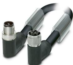
Cavo di alimentazione, 4-poli, PUR senza alogenati, nero RAL 9005, schermata (Advanced Shielding Technology), Maschio angolato M12, codifica: T, su Connettore femmina angolato M12, codifica: T, lunghezza cavo: 0,5 m, per corrente continua fino a 12 A / 63 V
