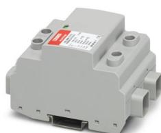
Scaricatore di corrente atmosferica / di sovratensione per sistemi fotovoltaici a tensione continua a 2 poli isolati e collegati a terra 1500 V DC, per montaggio su guida DIN, elementi di protezione monitorati termicamente, segnalazione di stato sul modulo.
