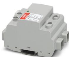
Scaricatore di corrente atmosferica / di sovratensione per sistemi fotovoltaici a tensione continua a 2 poli isolati e collegati a terra 1500 V DC, per montaggio su guida DIN, con contatto di segnalazione remota, elementi di protezione monitorati termicamente, segnalazione di stato sul modulo.
