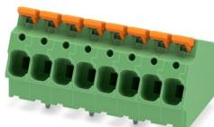
Morsetto circuito stampato, corrente nominale: 41 A, tensione di dimensionamento (III/2): 1000 V, sezione nominale: 6 mm<sup>2</sup>, numero dei potenziali: 8, numero di file: 1, numero di poli per fila: 8, serie di prodotti: LPTA 6/, passo: 7,5 mm, tipo di connessione: Connessione Push-in con leva, montaggio: Saldatura a onde, direzione di collegamento conduttore/scheda: 30 °, colore: verde, Layout Pin: Pinning a zigzag W, Lunghezza pin [P]: 3,6 mm, tipo di confezione: confezionato nel cartone
