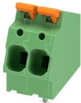
Morsetto circuito stampato, corrente nominale: 41 A, tensione di dimensionamento (III/2): 1000 V, sezione nominale: 6 mm<sup>2</sup>, numero dei potenziali: 2, numero di file: 1, numero di poli per fila: 2, serie di prodotti: LPTA 6/, passo: 7,5 mm, tipo di connessione: Connessione Push-in con leva, montaggio: Saldatura a onde, direzione di collegamento conduttore/scheda: 30 °, colore: verde, Layout Pin: Pinning a zigzag W, Lunghezza pin [P]: 3,6 mm, tipo di confezione: confezionato nel cartone
