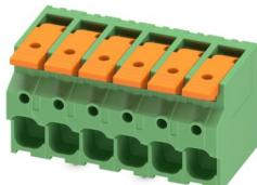
Morsetto circuito stampato, corrente nominale: 41 A, tensione di dimensionamento (III/2): 1000 V, sezione nominale: 6 mm<sup>2</sup>, numero dei potenziali: 6, numero di file: 1, numero di poli per fila: 6, serie di prodotti: LPT 6/, passo: 7,5 mm, tipo di connessione: Connessione Push-in con leva, montaggio: Saldatura a onde, direzione di collegamento conduttore/scheda: 0 °, colore: verde, Layout Pin: Pinning a zigzag W, Lunghezza pin [P]: 3,6 mm, tipo di confezione: confezionato nel cartone
