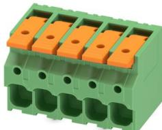
Morsetto circuito stampato, corrente nominale: 41 A, tensione di dimensionamento (III/2): 1000 V, sezione nominale: 6 mm<sup>2</sup>, numero dei potenziali: 5, numero di file: 1, numero di poli per fila: 5, serie di prodotti: LPT 6/, passo: 7,5 mm, tipo di connessione: Connessione Push-in con leva, montaggio: Saldatura a onde, direzione di collegamento conduttore/scheda: 0 °, colore: verde, Layout Pin: Pinning a zigzag W, Lunghezza pin [P]: 3,6 mm, tipo di confezione: confezionato nel cartone
