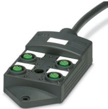
Scatola di distribuzione, applicazione: Standard, tipo di connessione: Connettore femmina M12 Plastica, numero degli slot: 4, numero poli: 5, codifica: A, occupazione slot: doppi, segnalazione di stato: sì, PNP; connessione linea principale: Attacco fisso 180°, PUR/PVC, lunghezza cavo: 15 m, schermatura: no
