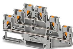
Morsetto a più piani, tensione nominale: 500 V, corrente nominale: 20 A, tipo di connessione: Connessione Push-in, 1., 2. e 3. piano, Sezione di dimensionamento: 2,5 mm<sup>2</sup>, sezione: 0,14 mm<sup>2</sup> - 4 mm<sup>2</sup>, tipo di montaggio: NS 35/7,5, NS 35/15, colore: grigio
