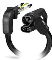
CHARX connect professional, CCS tipo 2, Cavo di ricarica HPC-DC, fino a 700 A in Boost mode, 500 A permanente, 1000 V DC, con connettore di ricarica lato veicolo e cavo raffreddato, cavi: 5 m, nero, diritto, con parte frontale del connettore sostituibile, con contatti di potenza DC sostituibili, con passaparete angolato a destra, con ventola a velocità variabile, Logo PHOENIX CONTACT, IEC 62196-3-1, per la ricarica con corrente continua (DC) di veicoli elettrici (EV)
