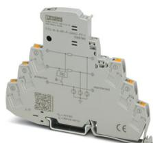
Protezione contro le sovratensioni con indicatore di stato integrato per tre fili di segnale con potenziale di riferimento comune. Per applicazioni HF e interfacce di telecomunicazione senza tensione di alimentazione (fino a 90 MBit/s). Messa a terra indiretta mediante scaricatore a gas.
